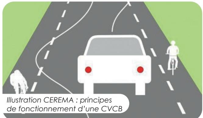
Les véhicules motorisés circulent sur une voie centrale bidirectionnelle et les cyclistes sur les accotements revêtus appelés « rives ».
